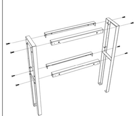
Рисунок 9. Соединить А-образные конструкции с продольными профилями, где нужно обратить внимание на положение и направление профилей.
