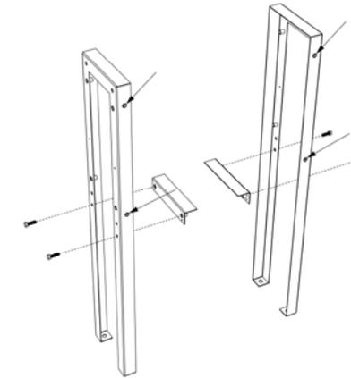
Рисунок 8. Соединить П-образный профиль с уголками. Обратить внимание на закладные гайки в П-образном профиле – это задняя сторона тумбы (при ОНШ-750-Х таких закладных нет).
