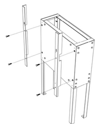
Рисунок 11. Присоединить уголки к тумбе. В дальнейшем к этим уголкам прислоняется и фиксируется задняя стенка шкафа. Данный шаг отсутствует для ОНШ-750-Х.
